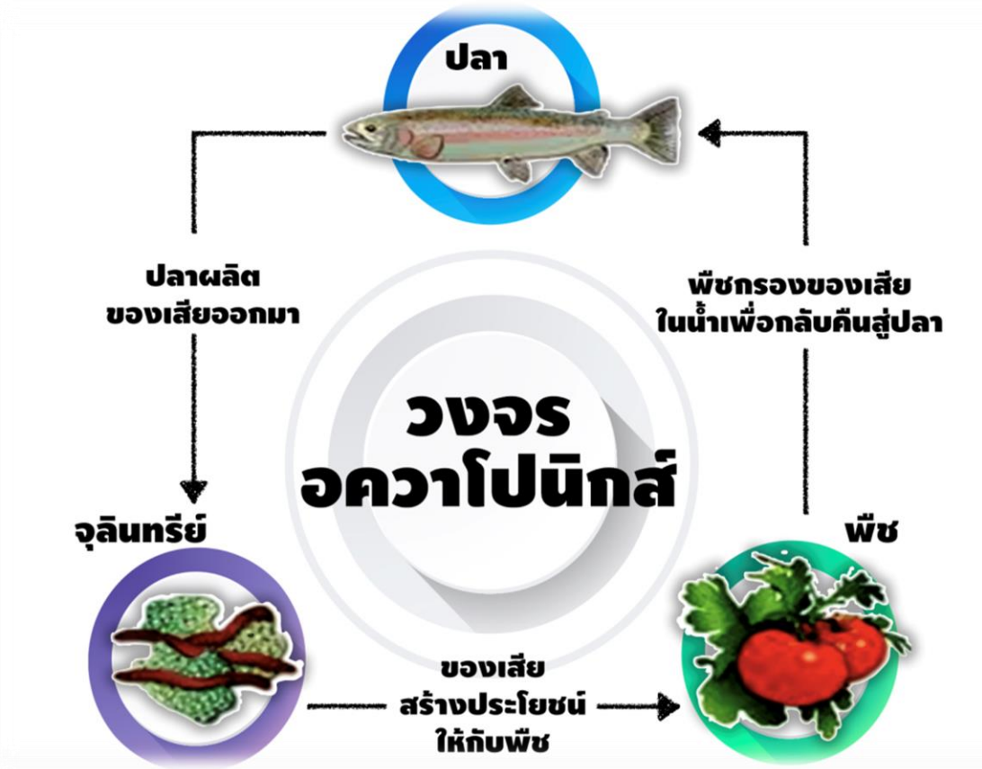
รูปที่ 2.2 แสดงการบริหารจัดการแบบวงจรวงจรรอควาโพนิก
