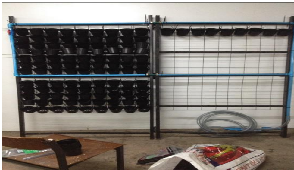
รูปที่ 3.1 แสดงการการผนังแขวนแนวตั้งสำหรับระบบระบบอะควาโพนิกส์แนวตั้ง
